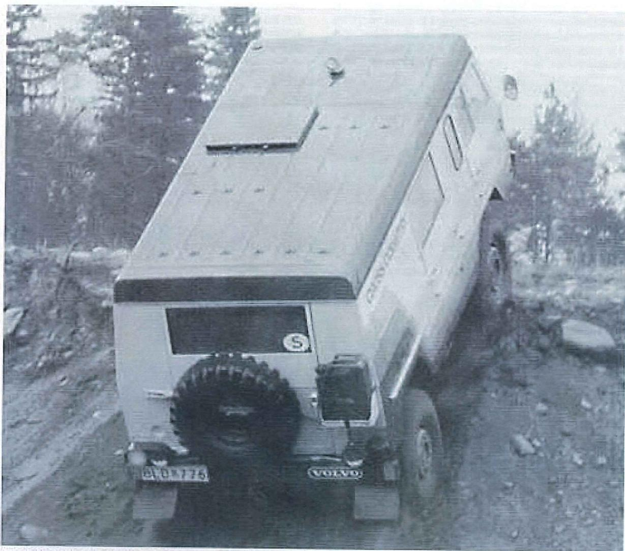
Volvo C 307 mit Reihen-Sechszylinder-Motor.
